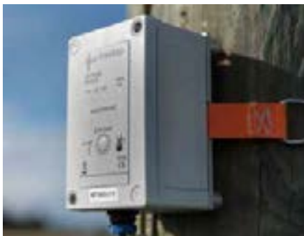
Schwingungssensor zur Aufnahme der Messdaten.
