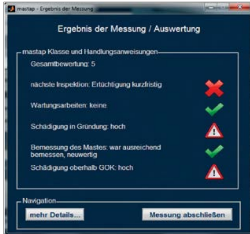
Bild 1: Ergebnis für die Messung der Standsicherheit eines Beleuchtungsmastes
